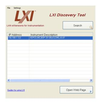
FIGURE 2-9. TYPICAL SCREEN USING LXI DISCOVERY TOOL
