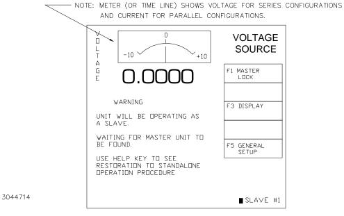
FIGURE 2-19. POWER ON DEFAULT SCREEN FOR SLAVE UNIT
