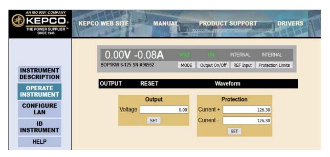
FIGURE 3-24. WEB INTERFACE OPERATE INSTRUMENT PAGE
