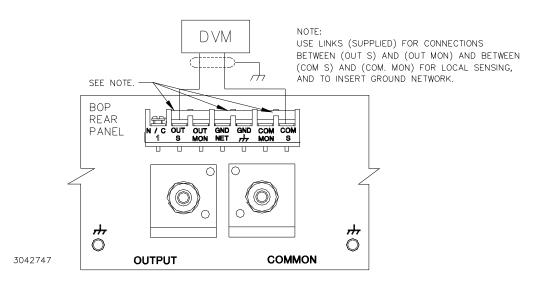
FIGURE 4-1. CALIBRATION SETUP FOR VOLTAGE MODE
