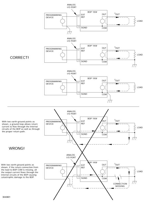
FIGURE 2-3. EARTH GROUND CONNECTION RECOMMENDATIONS
