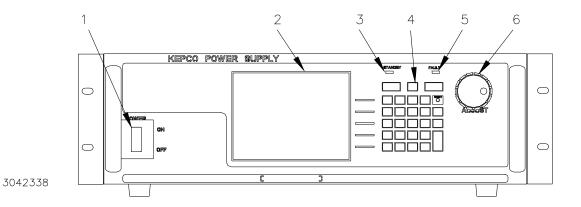
FIGURE 3-1. BOP SERIES FRONT PANEL
