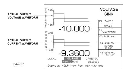
FIGURE 3-5. POWER-UP SCREEN SHOWING TIME LINE GRAPH
