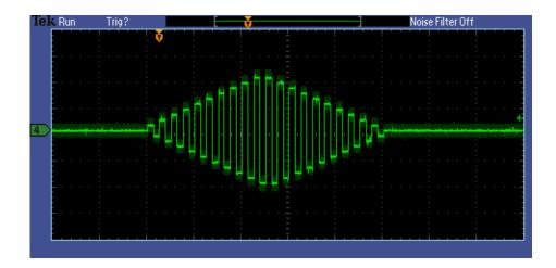
FIGURE B-11. SQUARE WAVE USING LIST:VOLT:APPL ZINC AND LIST:VOLT:APPL ZDEC WITH ELEVEN STEPS EACH (ZERO PLUS 10 NON-ZERO VALUES)
